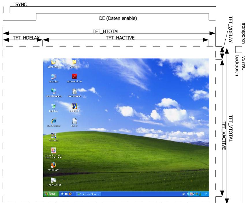
Die Timingparameter werden wie die Inverterdaten per RS232 übertragen. Horizontale Werte werden immer in Pixel, vertikale in Zeilen angegeben. Über das Kommando `tft_?` können Sie die aktuellen Einstellungen abfragen:
