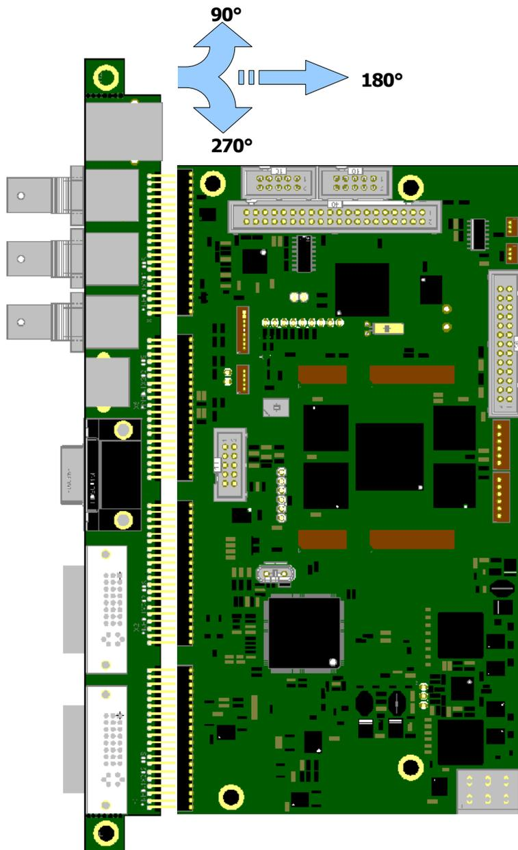
Kundenspezifische Varianten des Inputmoduls sind möglich und können auch selbst erstellt werden. Die Version „PMD1.0\_IM\_Hamburg“ ist bereits verfügbar. Buchsen und Lochbild dieses Moduls sind baugleich zu ähnlichen Produkten. Siehe Abbildung rechts. In der Standard Ausführung verfügt die PMD über eine RJ45 Buchse (Ethernet), 3 BNC (oder Chinch) für FBAS1..3 oder YCrCb, 1 MiniDIN für Y/C, HDSUB15 VGA und 2x DVI. Zusätzlich können bis zu zwei PMD\_HD3G Boards über Rundkabel angeschlossen werden.
