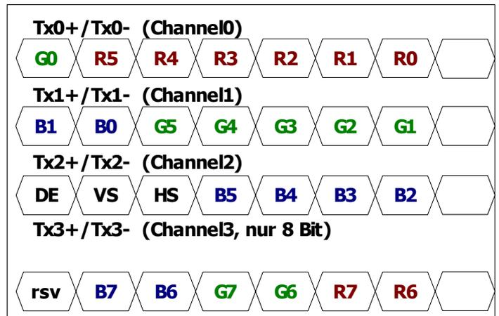
**Dual LVDS Schnittstelle :** die LVDS Datenrate liegt maximal bei 480MBit/s. Daher können auf einem Port Auflösungen bis zu XGA/WXGA übertragen werden.
