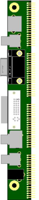
Displays werden über ein bzw. zwei 40 polige Stecker und ebenfalls über Rundkabel angesteuert. Die Displayversorgung (max 5A) ist abschaltbar. Displayspannungen von 3.3V, 5V oder 12V können aus einer Eingangsversorgung der PMD von 12V..18V erzeugt werden.
